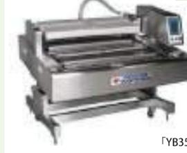
ベルト上に袋詰めされた商品を並べるだけで真空、シール、排出の工程を自動的に、量産に威力を発揮！ベルトが簡単に取外し可能なので、メンテナンス性が向上、清掃も簡単で衛生管理が容易です。
