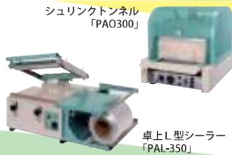
設置場所を選ばない省スペースの卓上型のシーラーとシュリンクトンネルです。多品種小ロットのシュリンク包装に最適！100V電源なので気軽に使用可能。
